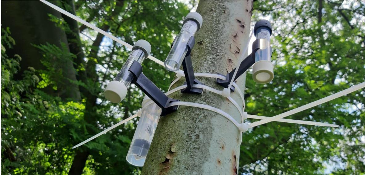
Sensoren zur Messung der Stickoxide und Ozon
