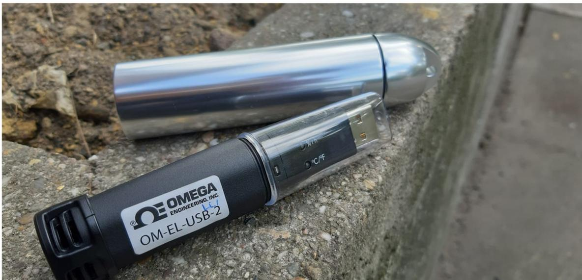
Messgerät zur Erfassung der Lufttemperatur und relativen Luftfeuchtigkeit
