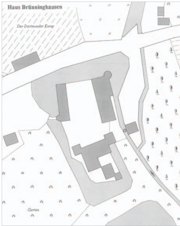
Maßstäbliche Umzeichnung der Urflurkarte von 1827 von Haus Brüninghausen (hellgrau: Teich, Gräfte und Schondelle, dunkelgrau: Gebäude, davon östlich des ehemaligen Schondelleverlaufes das Mühlengebäude, s. Seite 29).
