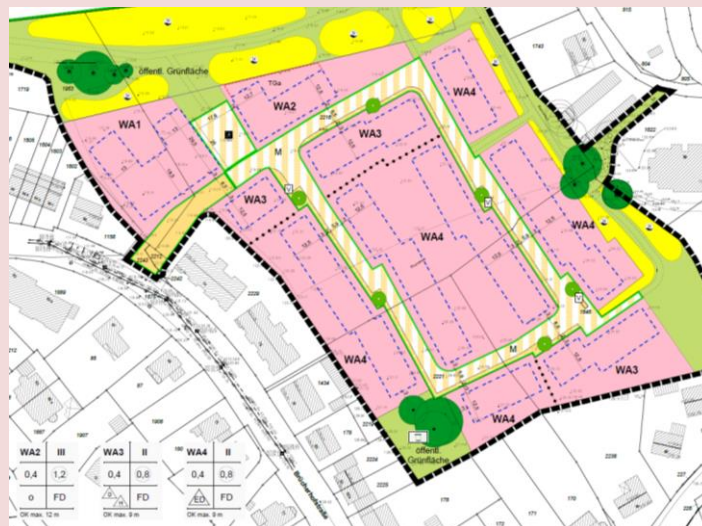
B-Plan Entwurf, Auf dem Wüstenhof, ca. 70 WE EFH, DHH, RH, davon 25% öffentlich geförderter Wohnungsbau, Stadt Dortmund, Stadtplanungs- und Bauordnungsamt
