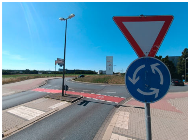
Kreisverkehr Emil-Figge-Straße: Die Radfurten wurden zusätzlich rotmarkiert, um die Vorfahrt des Radverkehrs zu verdeutlichen.
