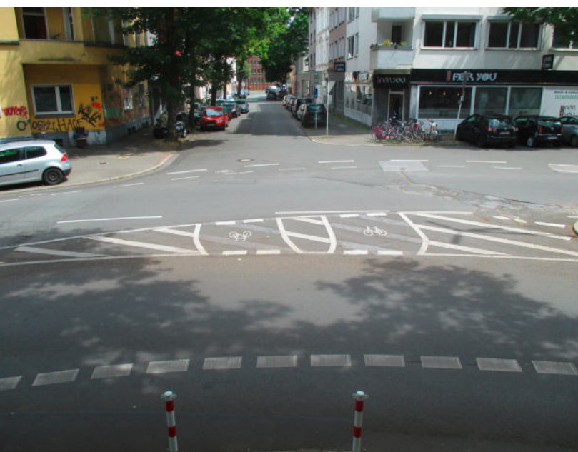
Vinckeplatz: In der Speerfläche wurden Linksabbiegemöglichkeiten für Radfahrende markiert.
