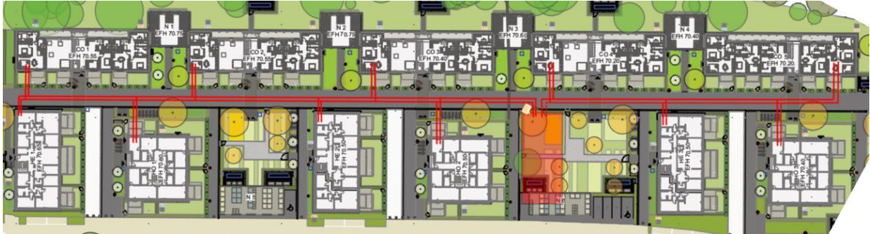
Abbildung 2: Aufbau Nahwärmenetz mit Pellet-Heizzentrale
