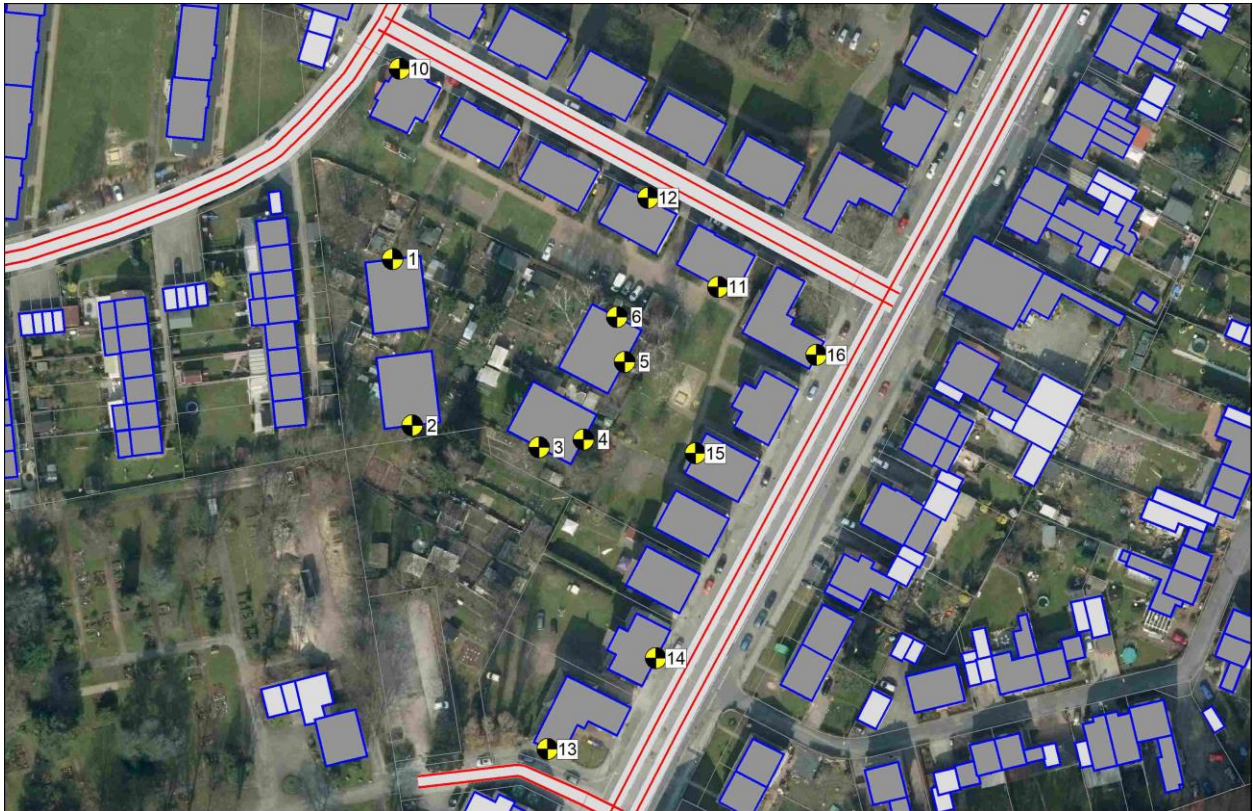
Abbildung 3: Auszug aus dem Berechnungsmodell nach DIN 18005 im Prognose-Planfall, IO im Plangebiet
