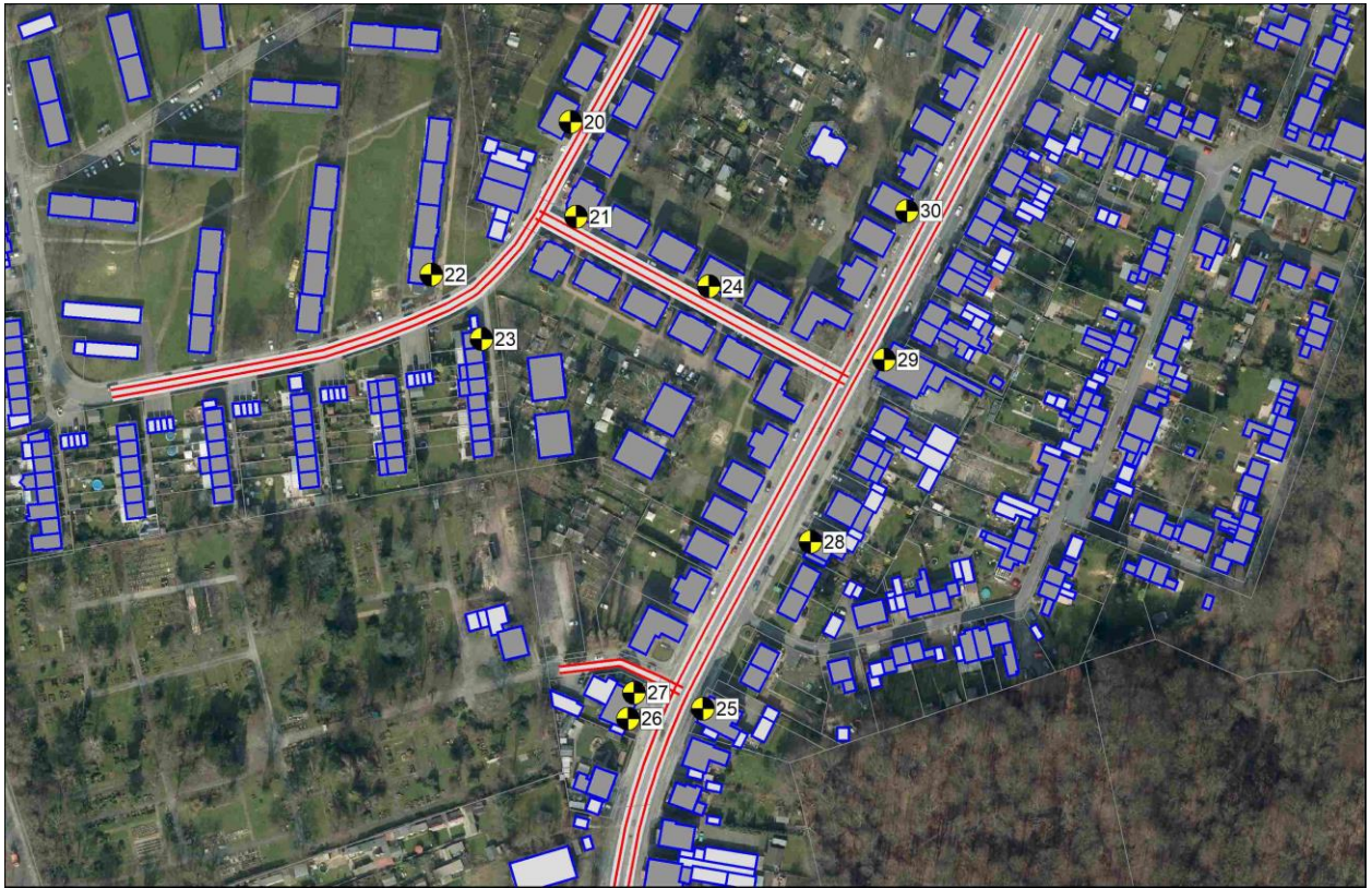
Abbildung 4: Auszug aus dem Berechnungsmodell nach DIN 18005 im Prognose-Planfall, IO im Umfeld
