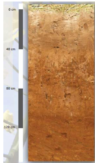
Abbildung 5: Beispiele für die gemäß Bodenkarte 1:50.000 im Untersuchungsgebiet des Gewerbegebietes Aplerbeck-Ost vorkommenden Bodentypen Tschernosem und Parabraunerde
