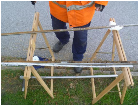
Erfassung der Bodeninformationen am Bohrgut (Bohrpunkt 4) (untere Bildhälfte: 0-1 m; obere Bildhälfte: 1-2 m uGOK)
