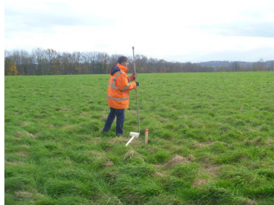
Probennahme mittels Handsondierung bis 2 m Bodentiefe (Bohrpunkt 10)
