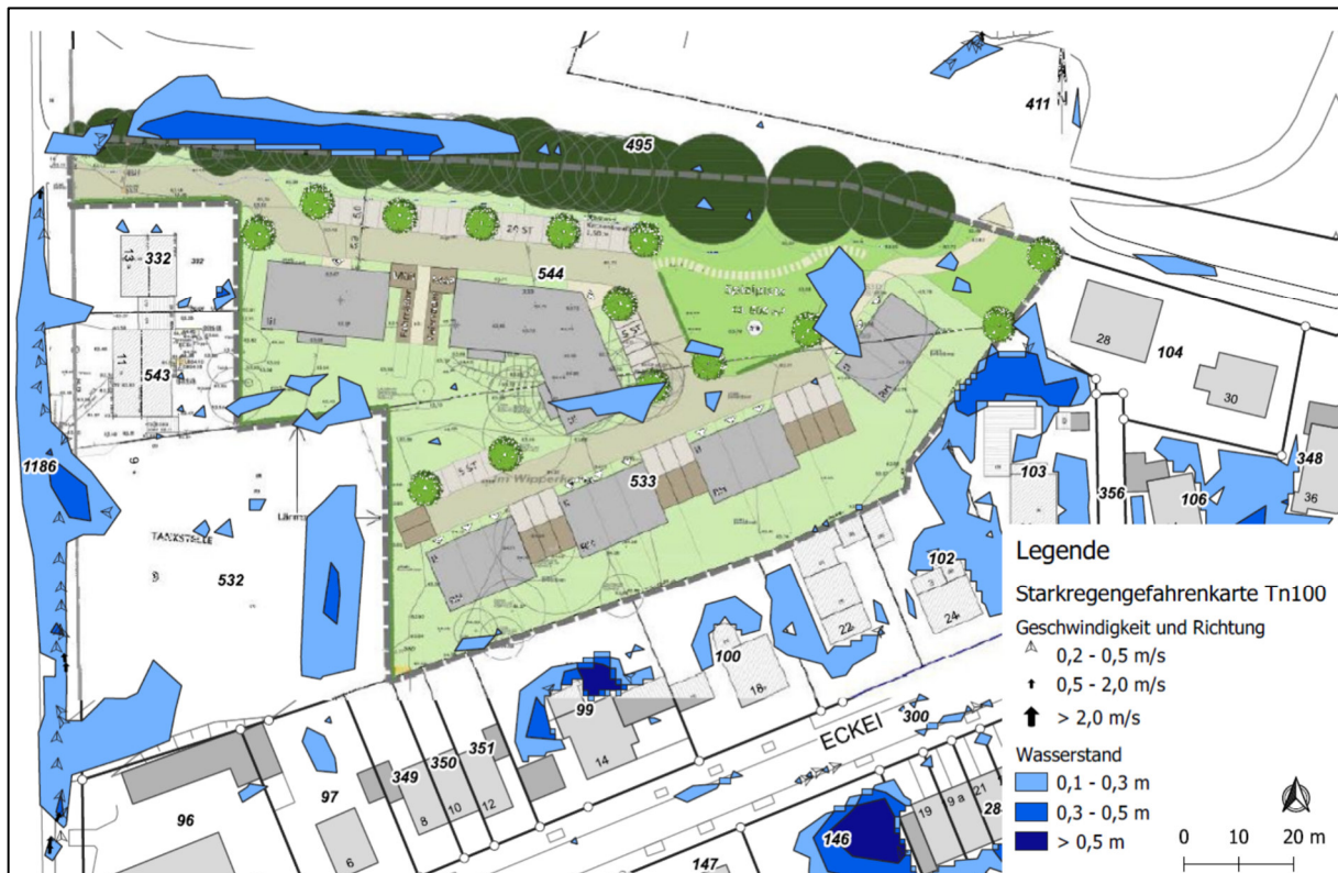
Abb. 9: Überlagerung des Plangebiets mit der Starkregengefahrenkarte
