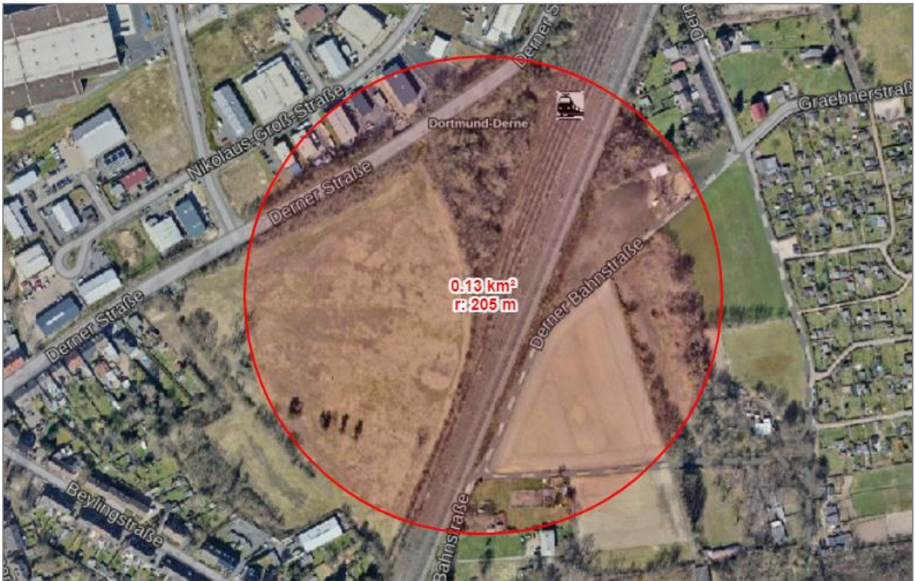
Abbildung 3-1: Beurteilungsgebiet gemäß Nr. 5.5.2.3 der TA Luft (2021) zur Berücksichtigung von geschlossener Bebauung und Bewuchs (Quelle: © LAND NRW (2023) – Lizenz dl-de/by-2-0 ( www.govdata.de/dl-de/by-2-0 ), mit Ergänzungen)
