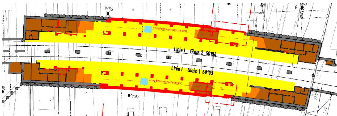
Abb. 30 Stadtbahnanlage Dortmund Hbf: Maßnahme Bahnsteigverbreiterung
