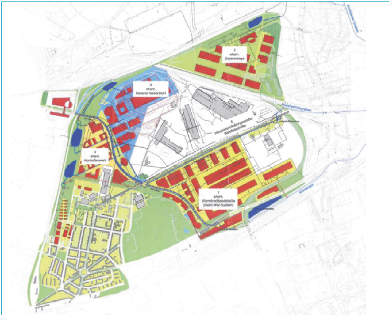
Abbildung 16: Rahmenplanung Westfalenhütte – Entwässerungskonzept und Regenwasserbewirtschaftung
