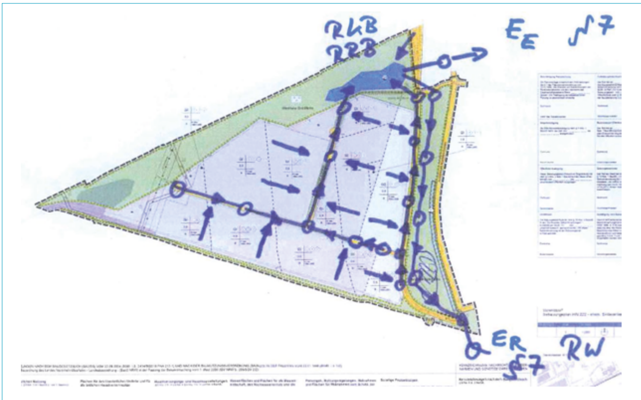
Abbildung 18: Bebauungsplan InN 222 – ehemalige Sinteranlage – Entwässerungsskizze
