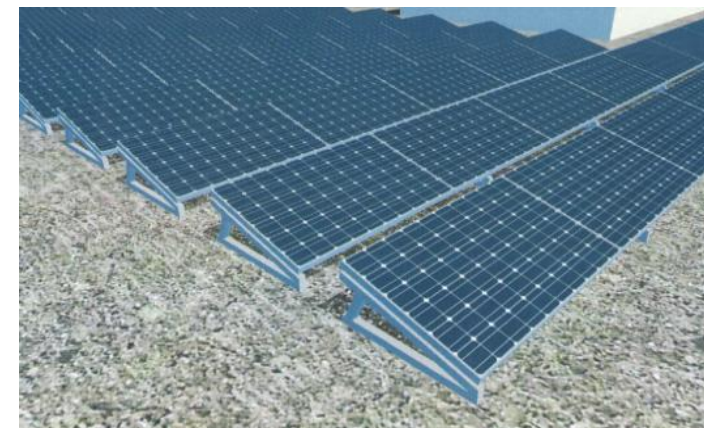
Aufständigung der Module – Neigung 15°
