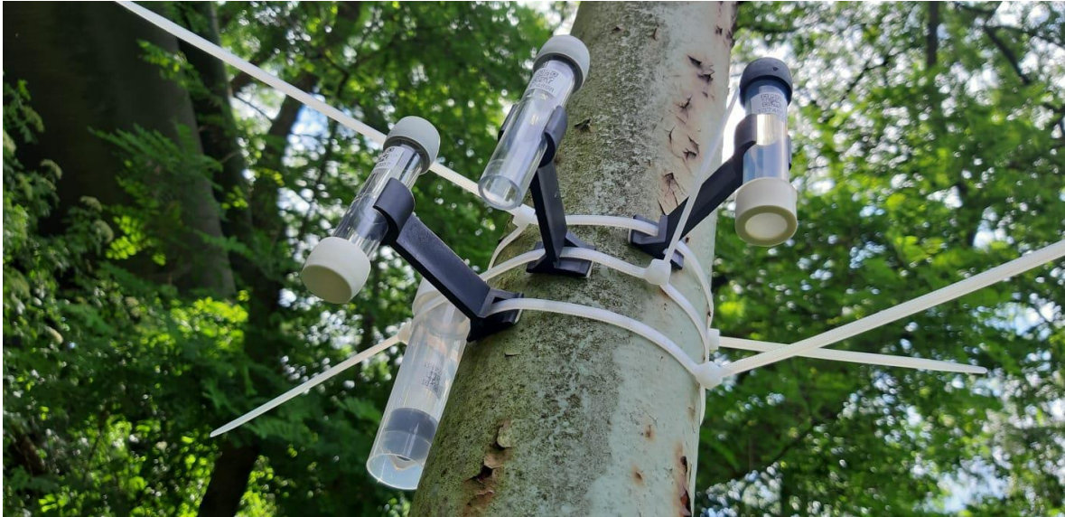
Sensoren zur Messung der Stickoxide und Ozon (Foto: Mais Jafari)
