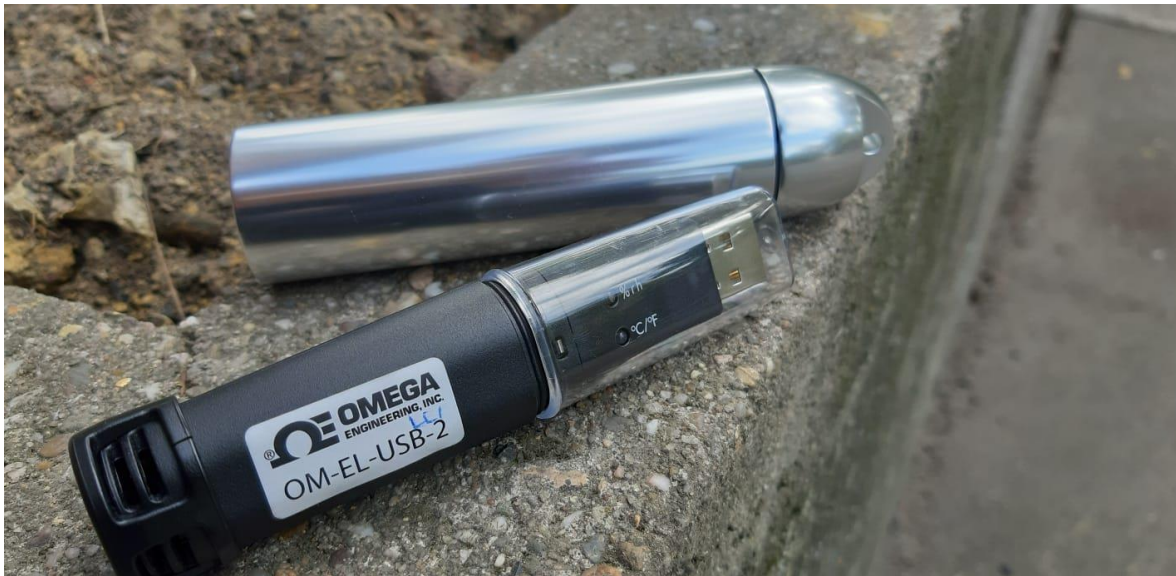
Messgerät zur Erfassung der Lufttemperatur und relativen Luftfeuchtigkeit (Foto: Mais Jafari)
